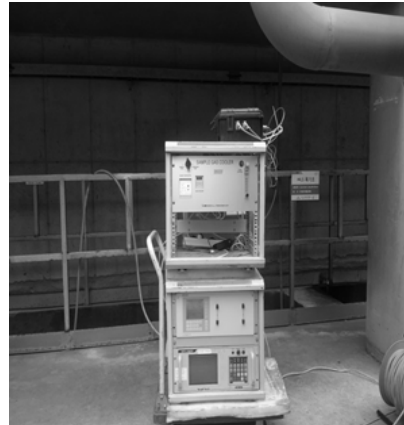
<그림 3-4> 온실가스 현장 측정 시스템
